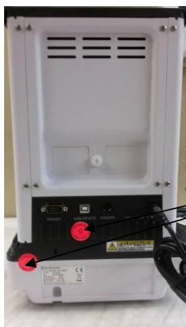
Рисунок 2 – Схема пломбирования от несанкционированного доступа
